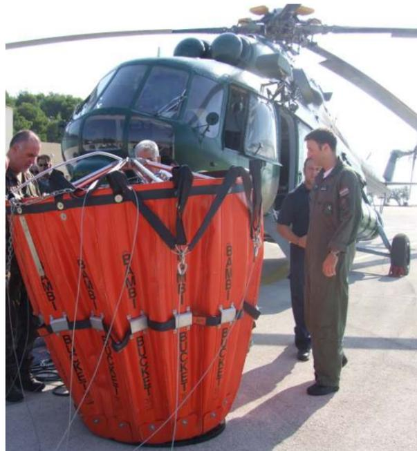
U zrakoplovnoj bazi Divulje prezentiran je i ispitana funkcionalnost uređaja za gašenje tipa *BAMBY BUCKET* na helikopteru PP NOS-a HRZ i PZO. Navedeni uređaj težak je 191 kg (bez vode), a 2600 kg kada je pun što u potpunosti odgovara mogućnostima helikoptera Mi8 MTV 1 opremljenih bravom za nošenje vanjskog tereta nosivosti 3000 kg.
