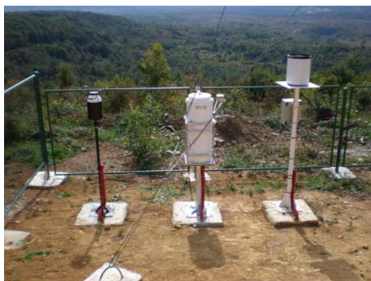
Slika 3. Instrumenti za praćenje kakvoće zraka na postaji vojnog vježbališta Slunj: sakupljač ukupne taložne tvari po Bergerhoffu (lijevo) i sakupljač oborine Eigenbrodt (sredina). Desno se nalazi ombrograf.
