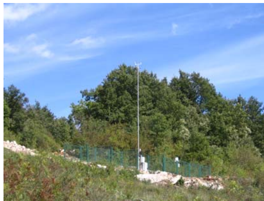
Slika 1. Automatska meteorološka postaja s instrumentima za praćenje kakvoće zraka na VV "Eugen Kvaternik" u Slunju.
