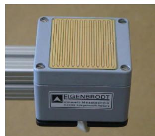
Slika 2. Sakupljač oborine Eigenbrodt: kućište s lijevkom, bocom i poklopcom (lijevo) i osjetnik oborine (desno).
