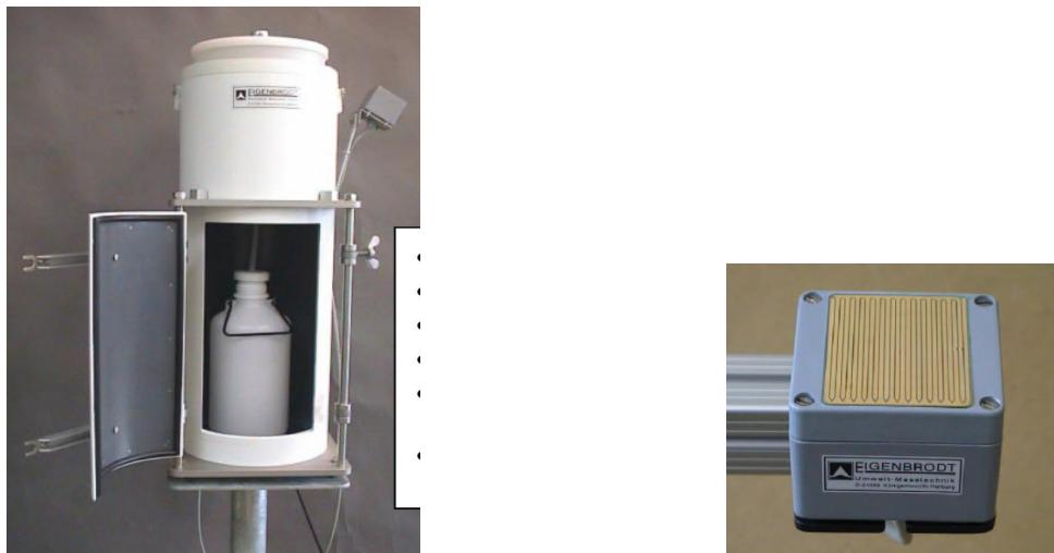
Slika 2. Sakupljač oborine Eigenbrodt: kućište s lijevkom, bocom i poklopcom (lijevo) i osjetnik oborine (desno).
