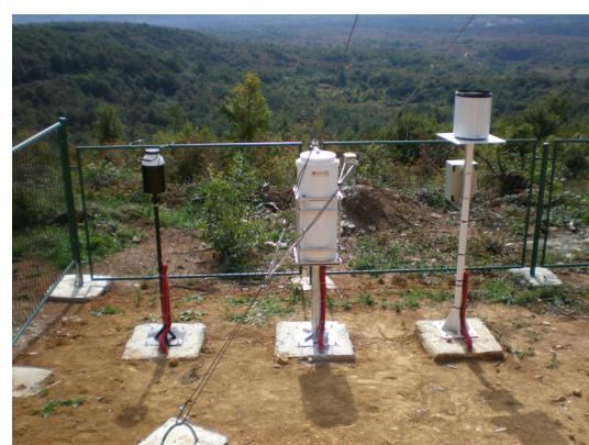
Slika 1. Automatska meteorološka postaja (lijevo) s instrumentima za praćenje kvalitete zraka (desno) na VP "E. Kvaternik" u Slunju.
