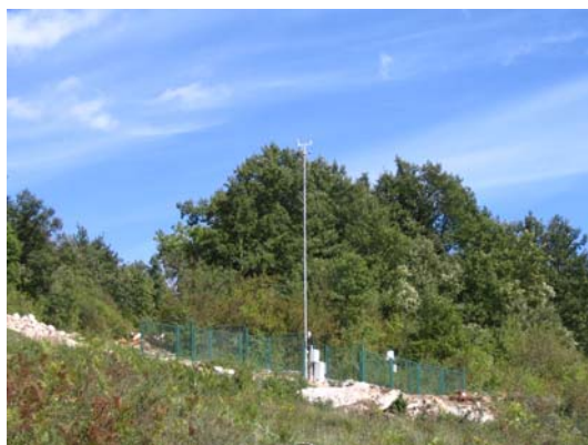
Slika 1. Automatska meteorološka postaja s instrumentima za praćenje kakvoće zraka na VP "Eugen Kvaternik" u Slunju.
