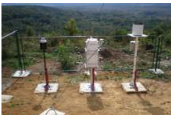
Slika 3. Instrumenti za praćenje kvalitete zraka na postaji vojnog vježbališta Slunj: sakupljač ukupne taložne tvari po Bergerhoffu (lijevo) i sakupljač oborine Eigenbrodt (sredina). Desno se nalazi ombrograf.
