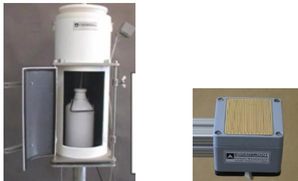
Slika 2. Sakupljač oborine Eigenbrodt: kućište s lijevkom, bocom i poklopcom (lijevo) i osjetnik oborine (desno).
