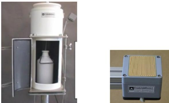
Slika 2. Sakupljač oborine Eigenbrodt: kućište s lijevkom, bocom i poklopcem (lijevo) i osjetnik oborine (desno).
