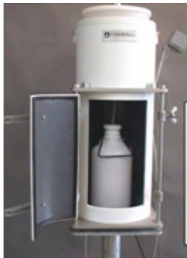
Slika 2. Sakupljač oborine Eigenbrodt: kućište s lijevkom, bocom i poklopcem (lijevo) i osjetnik oborine (desno).
