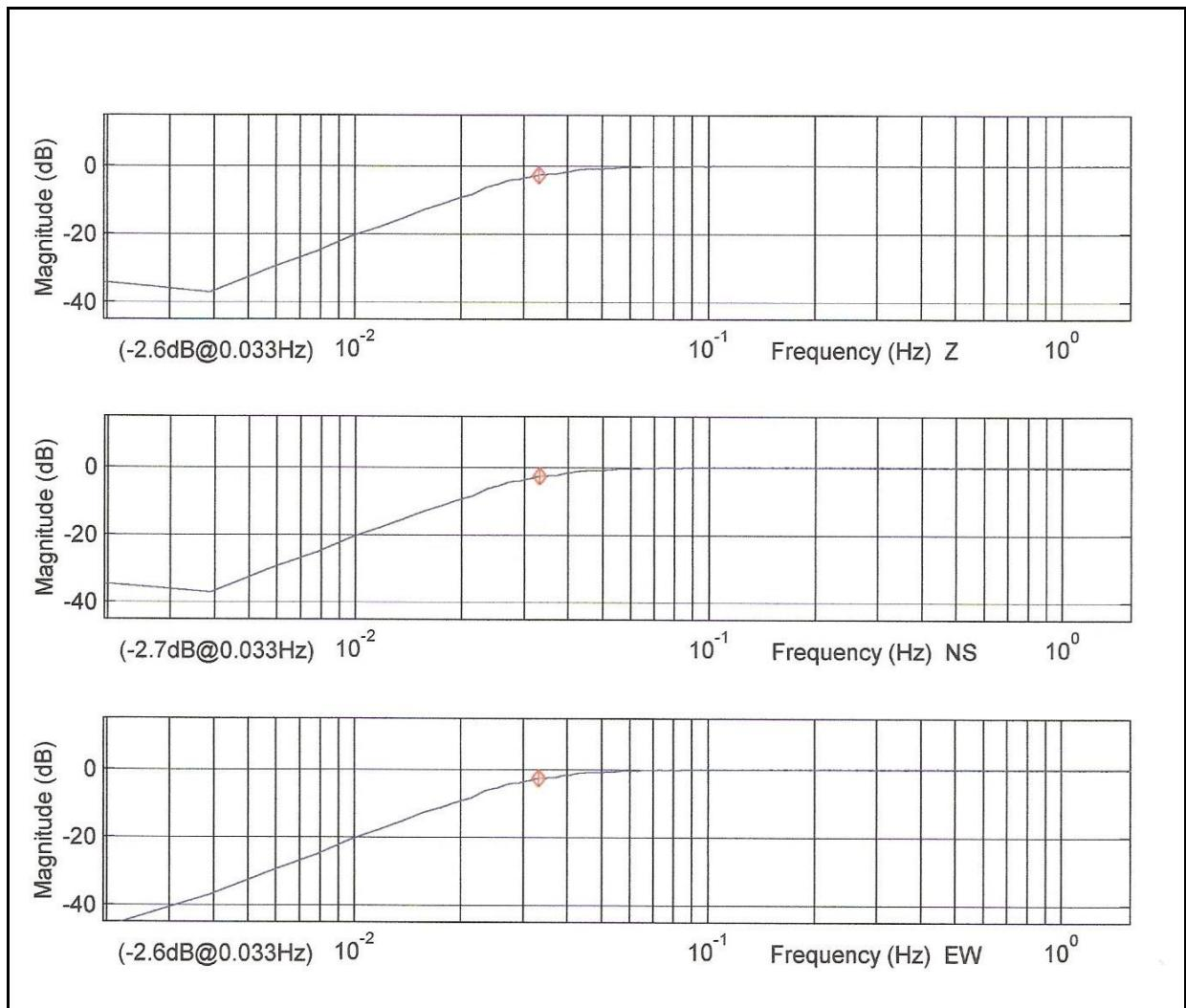
**Slika 2.1.a.** Krivulja dinamičkog povećanja u odnosu na brzinu u niskofrekventnom području za seizmometar postavljen na seismološkoj postaji Slunj na vojnom poligonu „Eugen Kvaternik”.
