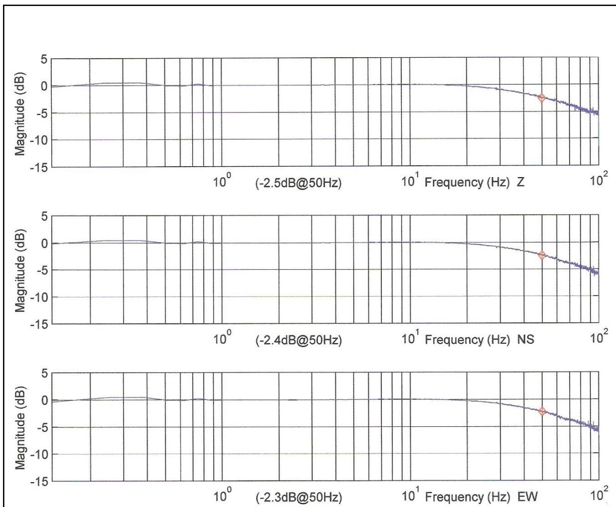
**Slika 2.1.b.** Krivulja dinamičkog povećanja u odnosu na brzinu u visokofrekventnom području za seizmometar postavljen na seismološkoj postaji Slunj na vojnom poligonu „Eugen Kvaternik“.
