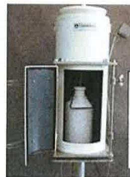
Slika 2. Sakupljač oborine Eigenbrodt: kućište s lijevkom, bocom, poklopcom i osjetnikom oborine.
