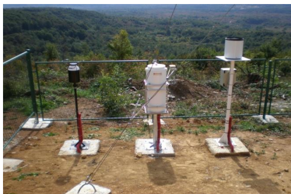
Slika 3. Instrumenti za praćenje kvalitete zraka na postaji vojnog vježbališta Slunj: sakupljač ukupne taložne tvari po Bergerhoffu (lijevo), sakupljač oborine Eigenbrodt (sredina), ombrograf (desno).
