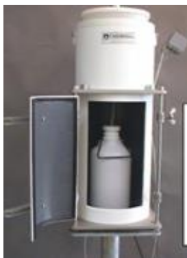
Slika 2. Sakupljač oborine Eigenbrodt: kućište s lijevkom, bocom, poklopcem i osjetnikom oborine.
