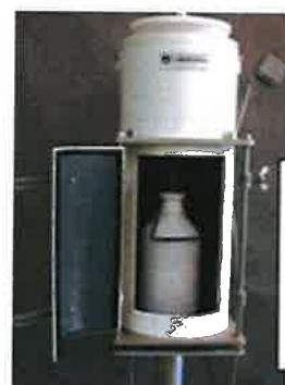
Slika 2. *Wet-only* sakupljač oborine: kućište s lijevkom, bocom, poklopcom i osjetnikom oborine.
