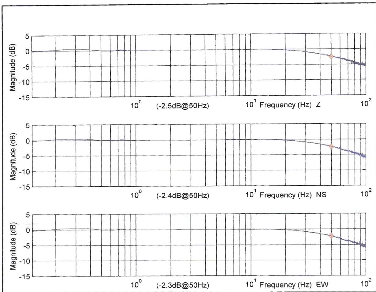
Slika 2.1.b. Krivulja dinamičkog povećanja u odnosu na brzinu u visokofrekventnom području za seizmometar postavljen na seismološkoj postaji Slunj na vojnom poligonu „Eugen Kvaternik”.
