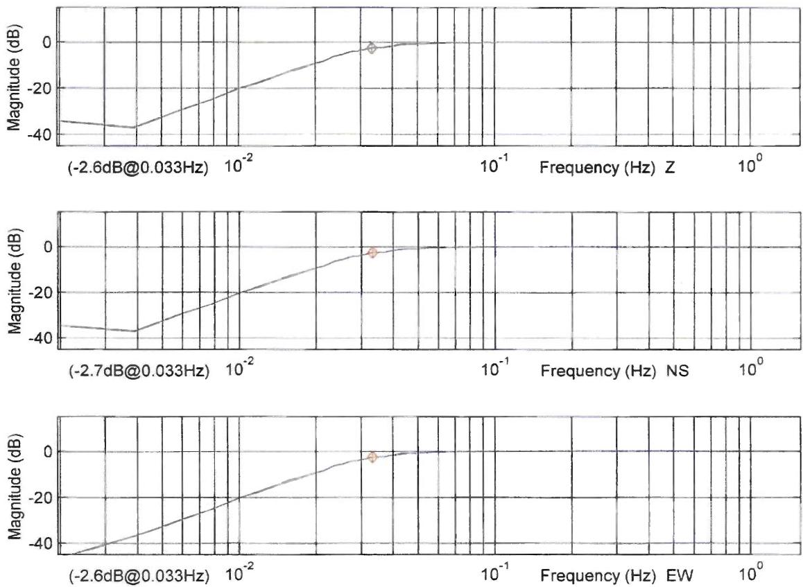
Slika 2.1.a. Krivulja dinamičkog povećanja u odnosu na brzinu u niskofrekventnom području za seismometar postavljen na seismološkoj postaji Slunj na vojnom poligonu „Eugen Kvaternik”.
