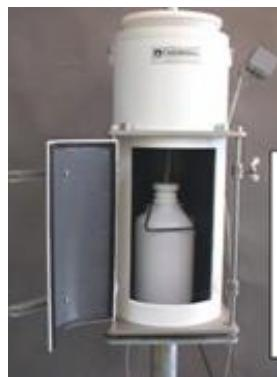
Slika 2. *Wet-only* sakupljač oborine: kućište s lijevkom, bocom, poklopcem i osjetnikom oborine.
