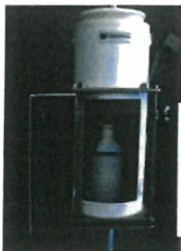
Slika 2. Wet-only sakupljač oborine: kućište s lijevkom, bocom, poklopcem i osjetnikom oborine.
